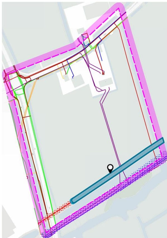
Afbeelding: resultaat KLIC-melding (rood = elektra, paars = riool, groen = data, geel = gas, blauw = water)
